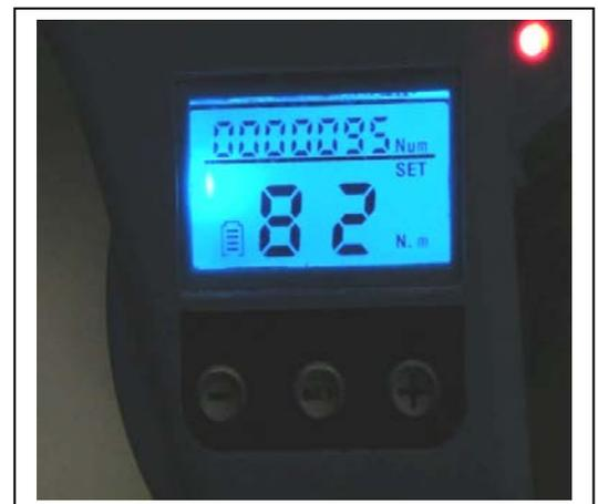
Réglage de la force de serrage, niveau batterie, longueur de fil choisi et affichage du nombre de cycle
