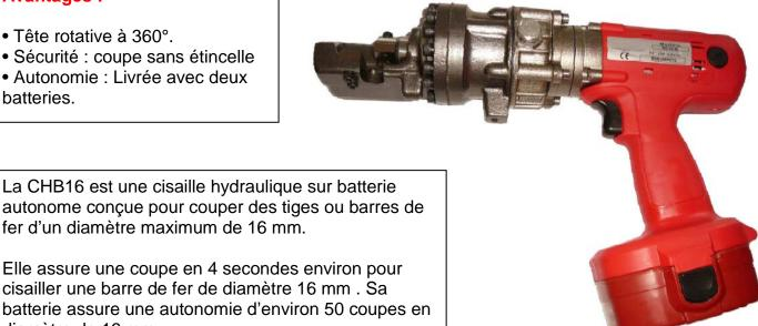
fer d'un diamètre maximum de 16 mm.
